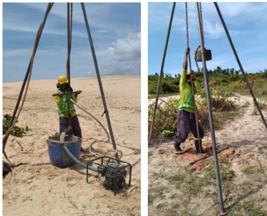
Foto 01 e 02: Sondagem à Percussão
